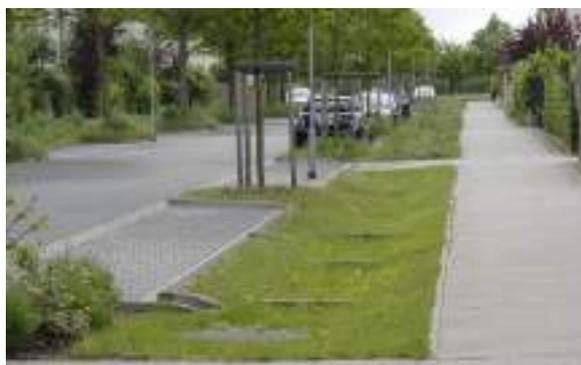
*Sistemas para recogida de pluviales y plantación.*
